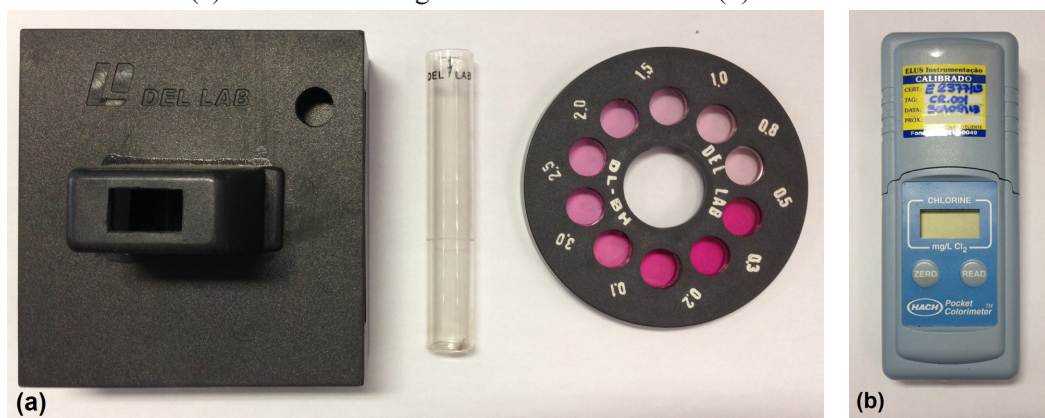
Figura 3 – Equipamentos utilizados na pesquisa. Conjunto com disco colorimétrico, marca Del Lab (a) e Clorímetro Digital Portátil marca Hach (b).
